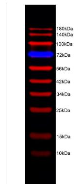
8–18%的Tris-glycine胶上样2u1的蛋白Ladders，电泳后转PVDF膜，封闭结束后直接使用Bio-Rad的ChemiDocMpImagingSystem设备550nm（72kDa）和680nm（除72kDa以外）双通道拍摄。
