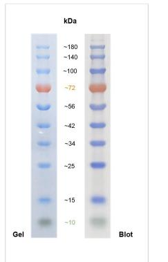
蛋白质常规分子量标记（10–180kDa）在8–18%Tris-glycine凝胶电泳和随后转移到膜上的条带分布图谱。
